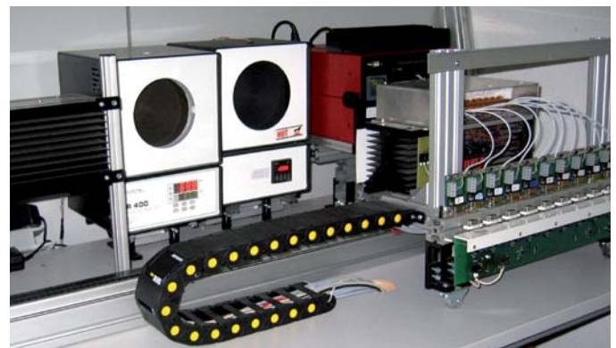
Automatisierte Kalibrierstation bei der Optris GmbH
