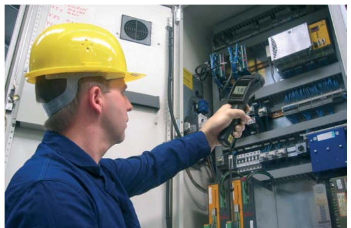
Detaillierte Infrarottemperaturmessung an einer elektrischen Steuerung mit Hilfe der eingebauten Scharfpunktoptik des optris LS LT im 1 Millimeterbereich
