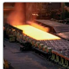
Bei Warmumformprozessen müssen enge Temperaturgrenzen eingehalten werden, um die Qualitätsansprüche an die Werkstoffe zu erfüllen. Zur sporadischen Kontrollmessung z.B. beim Schmieden und Biegen kommt das optris P20 2M zum Einsatz.
