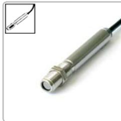
Zum Zweiten hat Optris Zweileiter-Geräte entwickelt, deren **Elektronik in das Kabel integriert** ist. Dadurch kann die Robustheit des Messkopfes entscheidend erhöht werden. Zudem hat die Wärmeentwicklung der Zweileiter-Elektronik keinen Einfluss auf die thermische Stabilität des Messkopfes.
