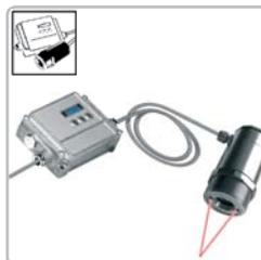
Beim Quotientenpyrometer sind **Messkopf** und **separate Elektronikbox** über ein **Glasfaserkabel** verbunden. Sowohl der Messkopf als auch das Glasfaserkabel können bei Temperaturen von bis zu **250°C** ohne zusätzliche Kühlung eingesetzt werden.
